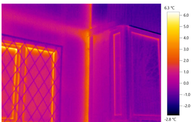
3.attēls. Balkona/ārsienas termiskais tilts, siltuma zudumi caur loga rāmja/stiklojuma savienojuma vietu
